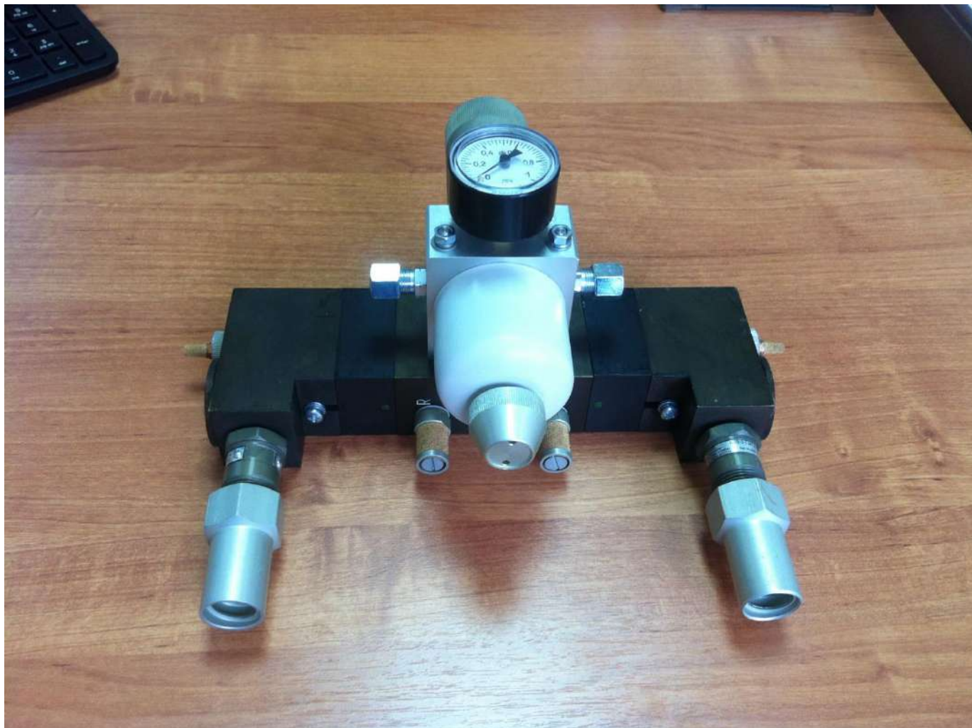
Рисунок Б.1 – Пример установки редуктора с фильтром РДФ-6/10 на корпусе клапана
